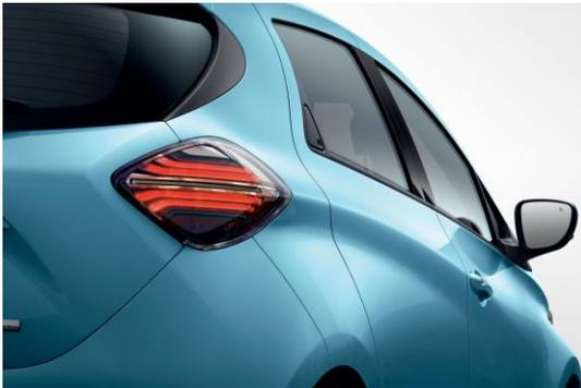
Die dreidimensional aus der Heckklappe herausgezogenen Rückleuchten wirken sich in einer optischen Verbreiterung der Heckpartie aus. Die horizontal ausgelegte Lichtsignatur – neu in Rot – sorgt für bessere Sichtbarkeit. Dasselbe gilt für die neuen LED-Blinkleuchten, die den Richtungswechsel dynamisch anzeigen, indem das Licht von innen nach aussen „läuft“. Die Blinkleuchten in den Aussenspiegeln sind ebenfalls zu 100 % in LED aufgebaut.
