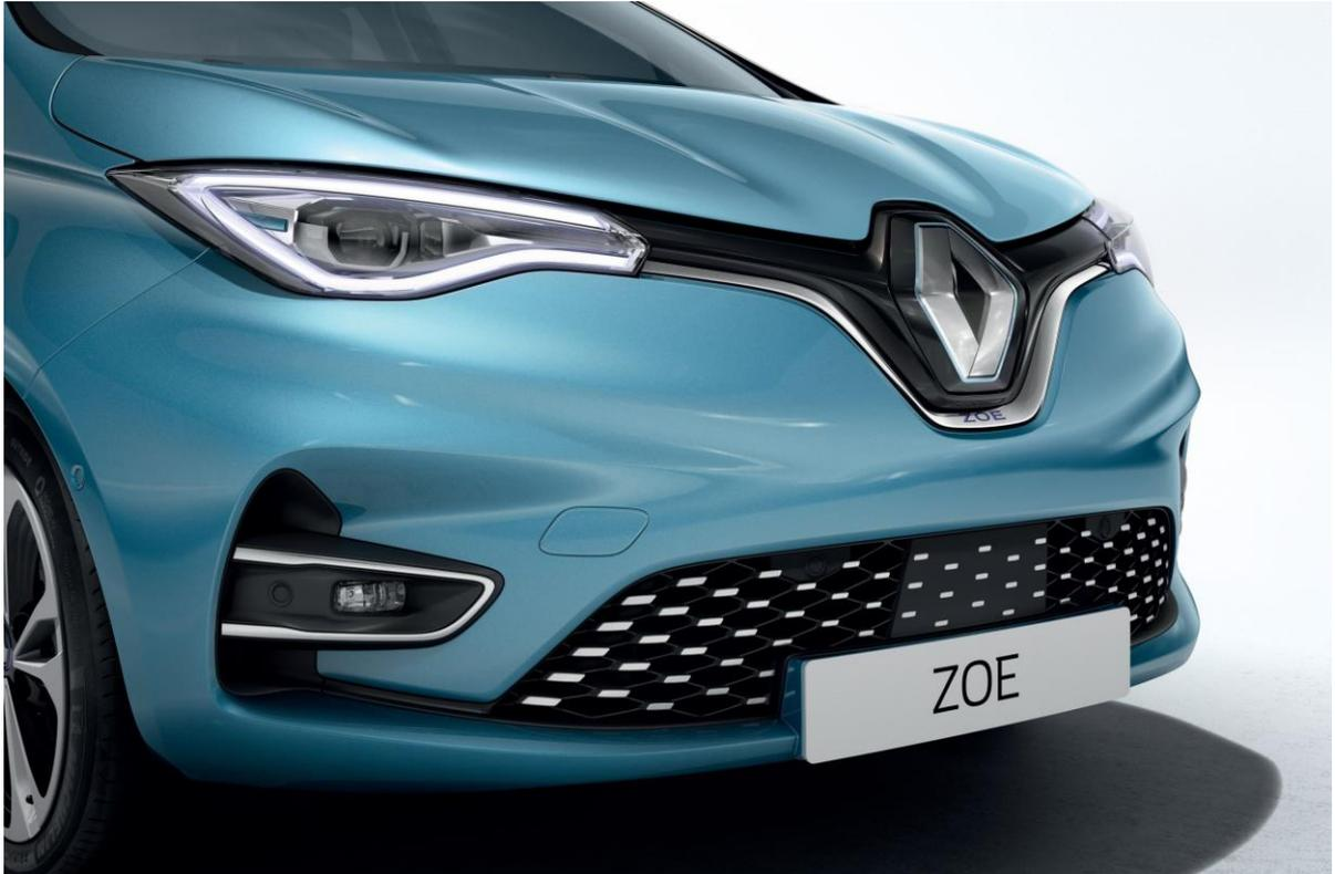
Die Frontpartie zeigt ein vollständig neues Design. Über die Motorhaube gezogene, nach vorn zusammenlaufende Sicken münden in Richtung Renault Emblem. Dieses dient gleichzeitig als Klappe mit dem darunter liegenden Ladeanschluss. Die neue Form der Stossfänger mit den Chromeinsätzen im Kühlergrill und um die Nebelleuchten hebt den unteren Teil der Front hervor. Seitliche Lufteinlässe in der Frontpartie optimieren zudem die aerodynamischen Qualitäten des Fahrzeugs.
