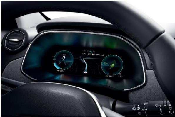
Die Anzeige bildet die wichtigsten Fahr-Informationen ab mitsamt den für den Elektroantrieb spezifischen Parametern – allem voran mit einem Eco-Fahrassistenten, der zum sparsamen Umgang mit der verbleibenden Energie animiert.
